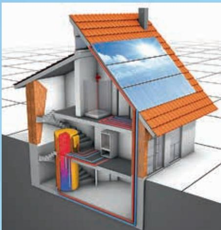
Ein großer Wasserspeicher ist das Herzstück des Sonnenhauses. Er kann beispielsweise in das Treppenhaus integriert werden, aber auch teilweise im Erdboden versenkt werden.
